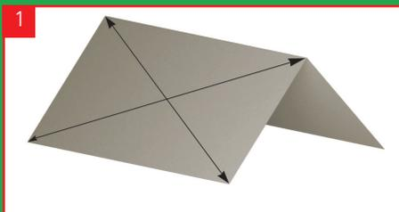
1. После установки стропил рекомендуется осуществить контрольный обмер скатов крыши, так как в процессе строительства возможны отклонения от проекта. Проверьте прямоугольность и плоскостность крыши, измерив диагонали скатов. Небольшие дефекты прямоугольности крыши (до 10 мм) можно скрыть с торцов с помощью доборных элементов.
