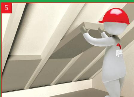
5. После установки гидроизоляции обеспечивается возможность одновременного проведения работ снаружи по устройству кровельного покрытия и теплозвукоизоляционных работ внутри помещения. Маты или плиты теплоизоляции устанавливаются враспор между стропилами, оставляя 20 мм вентиляционный зазор до гидроизоляционной пленки типа «ЮТАФОЛ Д СИЛВЕР» или «Изоспан А», в противном случае пленка потеряет свои свойства. Между утеплителем и пленками типа «ТАЙВЕК» или «ЮТАВЕК» зазор не нужен.
